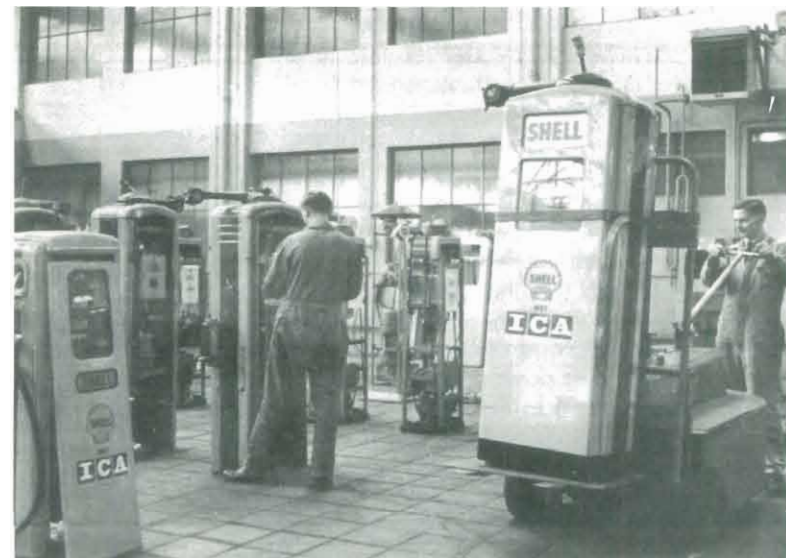
Revisie van benzinepompen in de centrale werkplaats van Shell Nederland N.V. aan de Calandkade. Afbeelding in: 'Olie' maandblad voor het personeel der tot de koninklijke/Shell groep behorende maatschappijen, 9 sep. 1954, blz. 265 (Haags Gemeente-archief).
